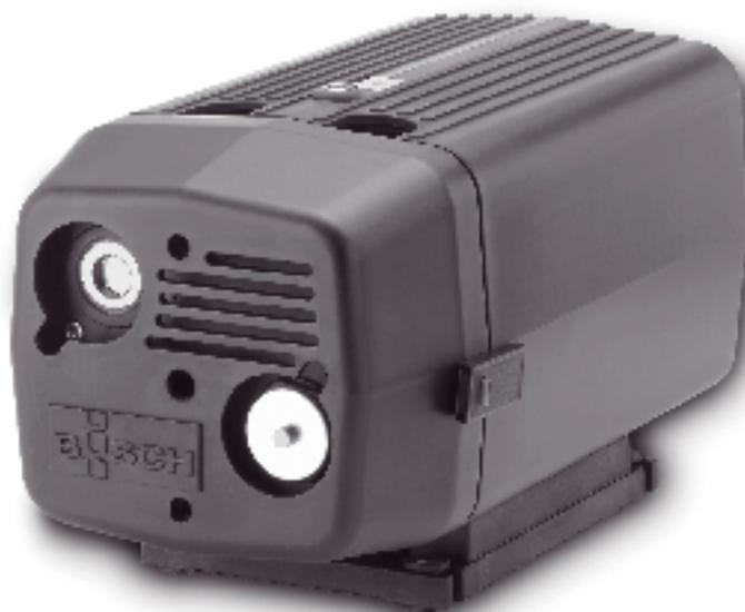
Seco SV Drehschieber-Vakuum-pumpen verdichten vollkommen Öl frei mit selbst schmierenden Schiebern aus Spezialkohle. Sie sind die idealen Vakuumerzeuger überall in der Industrie, wo absolut Öl freie Verdichtung gefordert wird. Mit dem Typ SD ist auch eine Überdruck-Version dieser Pumpe erhältlich.
